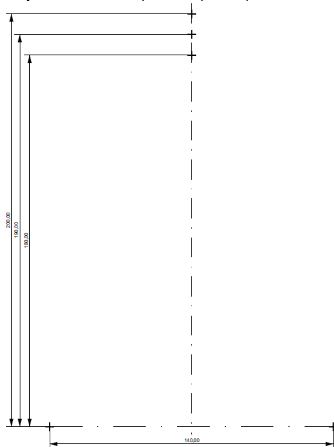
Рисунок А.2 – Установочные размеры счетчика
